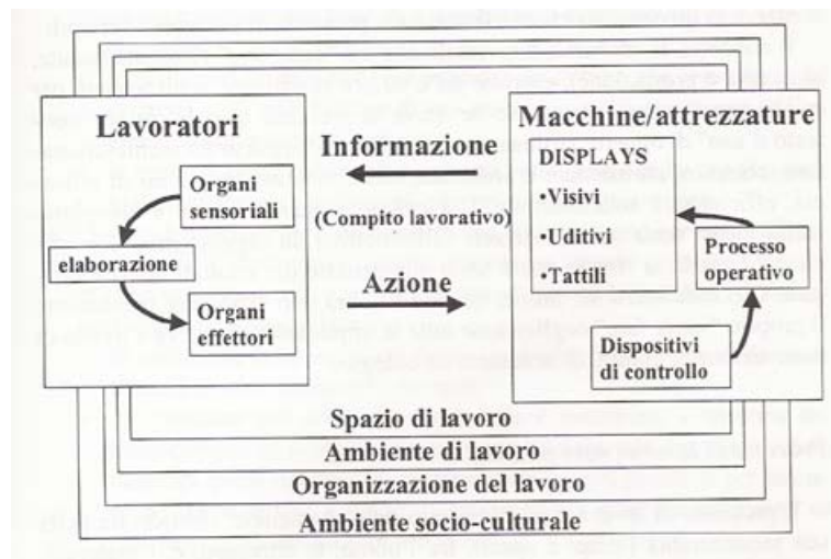
Fig. 4 – Modello delle interazioni tra lavoratore e sistema di lavoro
